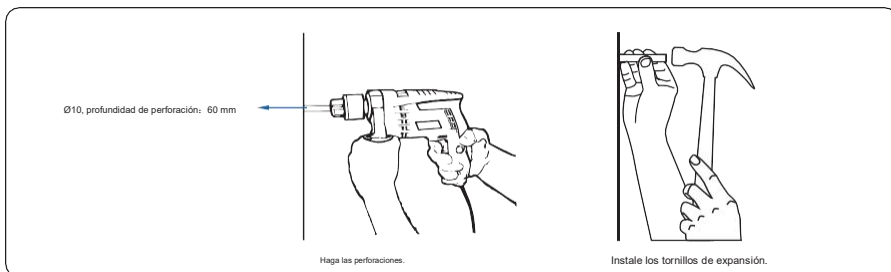
Figura 4.12 Perforaciones y tornillos de expansión (unidad: mm)
