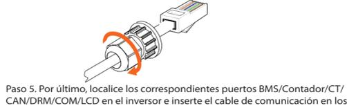
Paso 5. Por último, localice los correspondientes puertos BMS/contador/CT/DRM/COM/LCD en el inversor e inserte el cable de comunicación en los puertos correspondientes.
