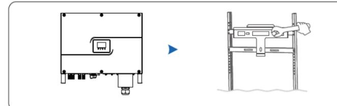
Paso 3 Apriete un tornillo a la derecha del inversor y el tornillo de retención en el soporte y verifique que estén bien asegurados.
