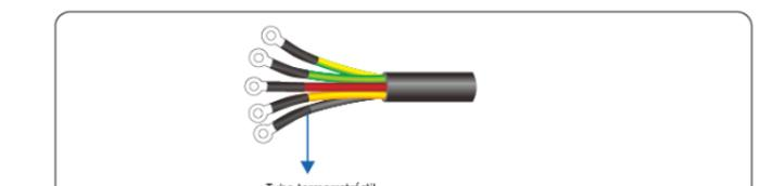
Paso 3 Suelte los cuatro tornillos de la compuerta de salida de CA y conecte L1, L2, L3, N y PE a través de la cubierta del terminal de salida de CA con el bloque de terminales; con un destornillador, atornille los conectores con un par de torsión de 3 N·m.
