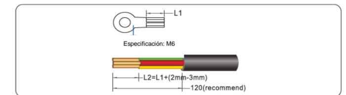
Paso 2 Inserte los cables con el núcleo visto en las zonas de prensado del terminal OT y engárcelos con unos alicates hidráulicos. Envuelva la zona de unión del cable con tubo termorretráctil o cinta aislante de PVC.
