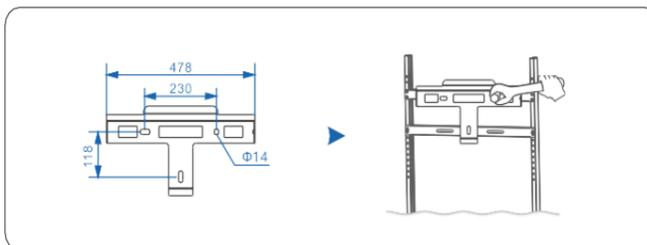
Paso 2 Monte el inversor en el soporte de fijación posterior, manteniéndolos ambos bien alineados.
