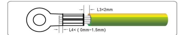
Paso 3 Fije el cable PGND con el tornillo de tierra y apriételo con un par de torsión de 1,2 Nm.
