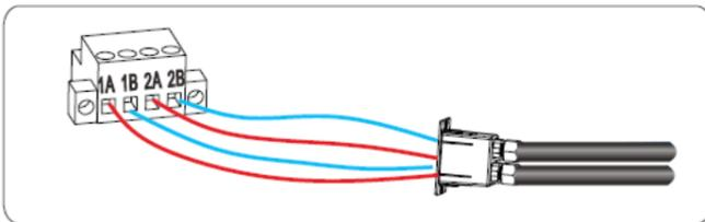
Paso 5 Conecte el terminal positivo RS485 con su terminal negativo. Apriete las tapas de bloqueo con un par de torsión de 8 Nm, y ajuste también los conectores impermeables de los cables.
