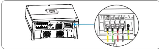
Paso 4 Vuelva a bloquear la carcasa del terminal de salida CA en la posición original, estire todas las líneas por el extremo de CA, sin forzar, y luego ajuste el enchufe.
